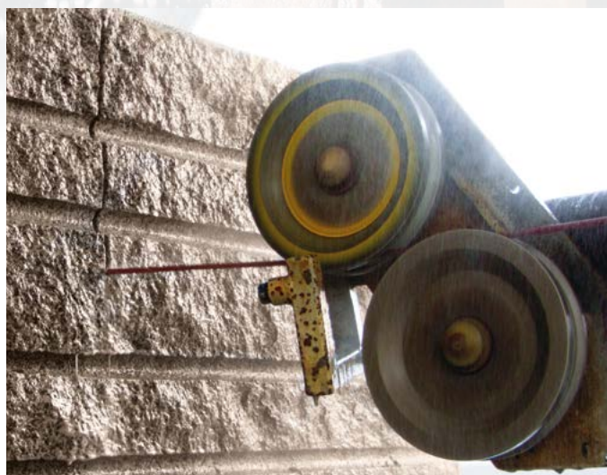
■ Дисковые и канатные станки распилят блоки на заготовки необходимой толщины.
