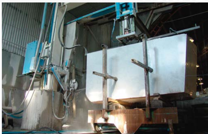
■ Дисковые и канатные станки распилят блоки на заготовки необходимой толщины.
