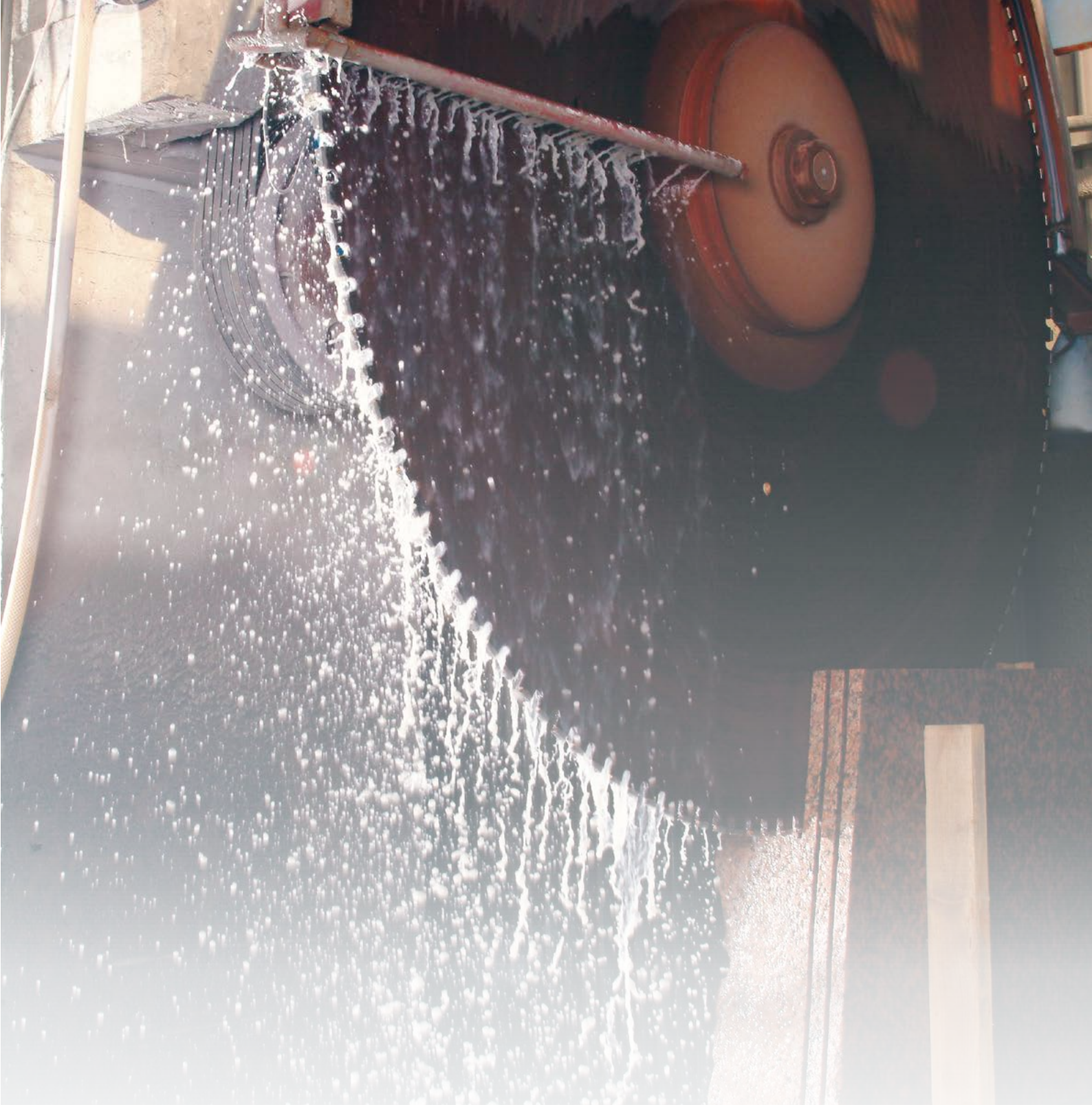
■ Дисковые и канатные станки распилят блоки на заготовки необходимой толщины.
